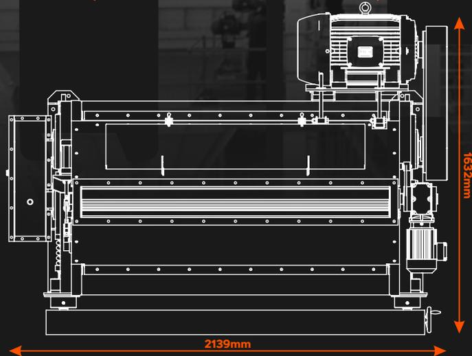
Rolos quebrantadores de **250 mm** de diámetro y **1500 mm** de largo montados sobre soportes GH de fundición nodular, rodamientos tipo doble hilera de rodillos a rótula y manguitos de fijación. El rolo fijo recibe la potencia de un motor de **20 CV** a **1200 rpm**.
